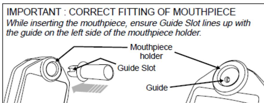
Desenvuelva la boquilla de su embalaje de protección y, con la guía de orientación de la ranura, deslice la boquilla en la embocadura (con la pantalla del alcoholímetro frente a usted y botones en la parte superior).
