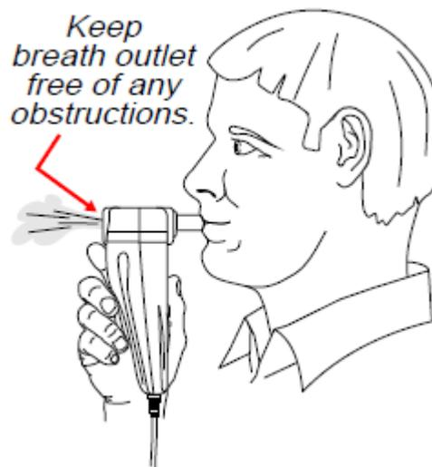
Nota: El alcoholímetro está equipado con sofisticados métodos para la detección de manipulaciones. Cualquier intento de arrancar su vehículo sin proporcionar una prueba de alcohol se registrará en el sistema y puede ser requerido para explicar sus acciones en un futuro.
